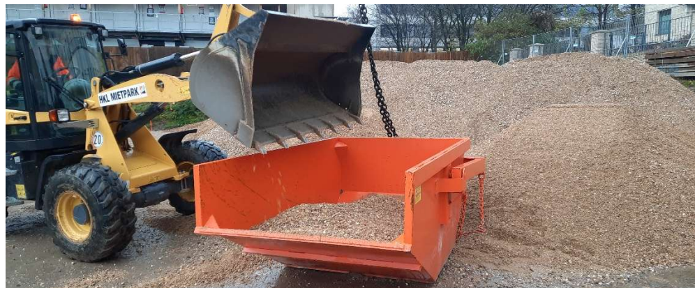
Mulde bei der Beladung durch den Radlader
