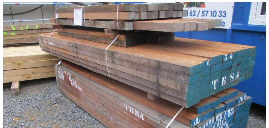
Konstruktionsholz zur Ausfachung der Stahlträger
