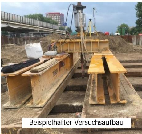
Die eigentlichen Zugversuche an den fünf Pfählen beginnen, nachdem die Prüfkonstruktion installiert ist und sind am 26., 27. und 28. Oktober sowie am 2. und 3. November vorgesehen. Die Versuche müssen gemäß Normung in definierten Belastungsstufen durchgeführt werden. Für die Zugversuche ist je Pfahl eine Dauer von circa 12 Stunden vorgesehen.
